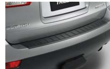
7 Stoßfängerschutzleiste E771SXA100 ★ W Zum Schutz des Stoßfängers beim Einladen.
