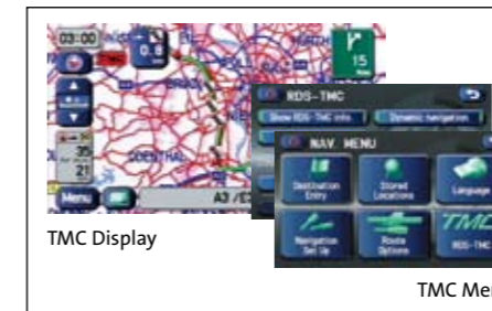
49 TMC-Einheit H001EAG102 W Gibt Verkehrsmeldungen durch und errechnet Ausweichrouten zum Umfahren von Staus.
