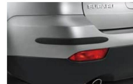
6 Stoßfängerschutzstecksatz für hinten J1010LE200 ★ W Ein wirksamer Schutz bei leichten Berührungen.
