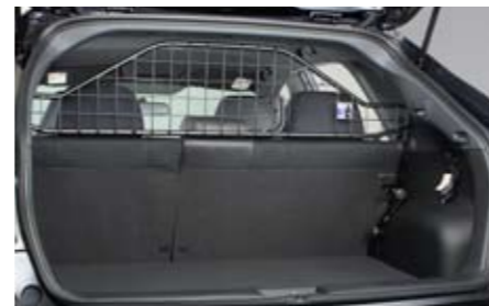
50 Laderaumtrenngitter F555EFG000 ★ W Trennt den Laderaum vom Insassenbereich, auch bei Verwendung von ISOFIX-Kindersitzen geeignet.
