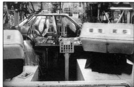
Punkt-Schweiß-Roboter: Im neuen, hochmodernem Yajima-Werk arbeiten pausenlos 102 vollautomatische Schweiß-Roboter
