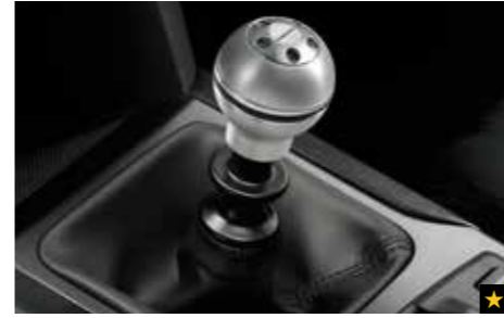
95 Aluminiumsportschaltknopf (6-Gang Schaltgetriebe) C105ESC000
