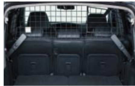
31 Laderaumtrenngitter F5515XA200 ★ W Trennt den Laderaum vom Insassenbereich, auch bei Verwendung von ISOFIX-Kindersitzen geeignet.
