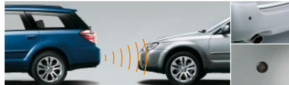
79 Ultraschall Einparkhilfe mit 2 Sensoren für vorne/4 Sensoren für hinten SEWAYA2100, SEWAYA2000 ★ E Vorne: Erleichtert das Einparken wesentlich. Aktivierung über Parklichtschalter. Akustische Warnung. Hinten: Erleichtert das Einparken wesentlich. Aktivierung durch Einlegen des Rückwärtsgangs. Akustische und optische Warnung.
