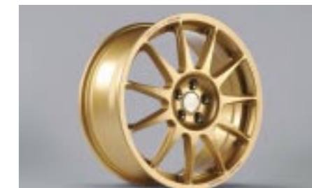
13 Alufelge 8,0 x 18", ET 48 - Speedline, Gold lackiert SESLSE4010 ★ E Nabenkappe zusätzlich notwendig.
