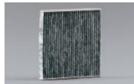
64 Innenluftfilter (Aktivkohle) G3010AG100 ★W Vermindert das Eindringen von Staub und Pollen in den Innenraum und hält zusätzlich unangenehme Gerüche fern. Um die Wirkung zu erhalten, sollte der Filter jährlich oder alle 15.000 km gewechselt werden.
