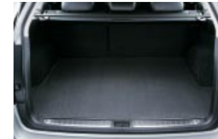
53 Textilmatte für den Laderaum J51SEAG000 ★ W Schützt den Laderaum vor Verschmutzung. Teppich mit Luftreinigungsfunktion.
