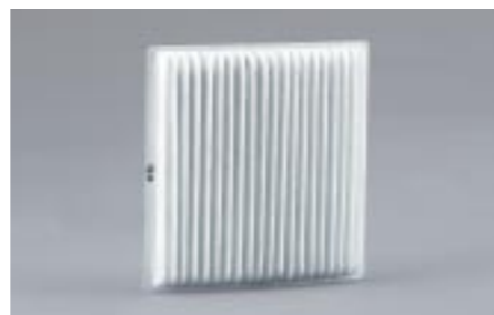
65 Innenluftfilter 72880AG000 ★W Vermindert das Eindringen von Staub und Pollen in den Innenraum. Um die Wirkung zu erhalten, sollte der Filter jährlich oder alle 12.000 km gewechselt werden.
