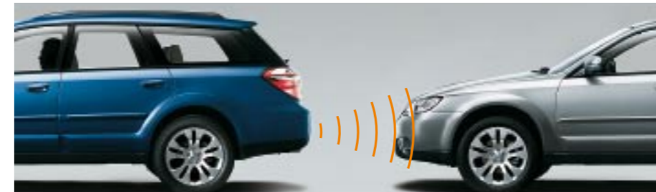
80 Ultraschall Einparkhilfe mit 4 Sensoren für hinten/ Zusatzsensor (2 oder 4 Stück notwendig) für Erweiterung von 2470 für vorne 2470/2470-01 ★ N Erleichtert das Einparken wesentlich. Aktivierung durch Einlegen des Rückwärtsgangs. Akustische und optische Warnung.
