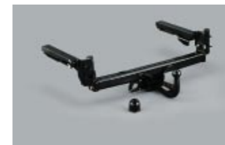
44 Anhängerkupplung abnehmbar/starr L101EAG071/L101EAG070 ★ W System AL-KO, für Fahrzeuge mit Niveauregulierung.
