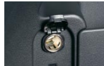
59 12V Steckdose für Laderaum H6710AG000 ★ W 12V Anschluß zur zusätzlichen Stromversorgung.
