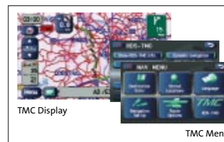
78 TMC-Einheit zu H001EAG006 H001EAG102 W Gibt Verkehrsmeldungen durch und errechnet Ausweichrouten zum Umfahren von Staus.
