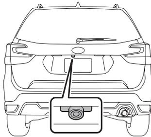
Wenn sich der Zündschalter in der Position „ON“ und der Wählhebel in der Position „R“ befinden, zeigt die Rückfahrkamera automatisch das Bild der Sicht nach hinten hinter dem Fahrzeug an. Das Bild der Rückfahrkamera wird auf diesem System angezeigt.
