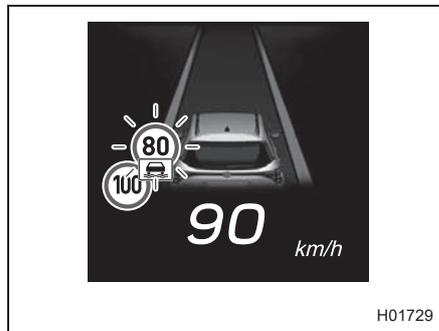
Die Anzeige hört nach einer bestimmten Zeit auf zu blinken. Der Alarm stoppt, wenn das Gaspedal losgelassen wird, wenn das Bremspedal betätigt wird oder nach einer bestimmten Zeitspanne.
