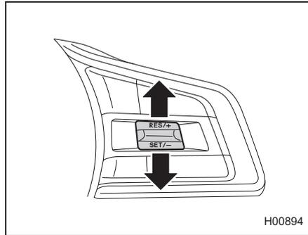
Wenn die adaptive Abstands- u. Geschwindigkeitsregelung aktiviert wird, schaltet sich **READY** (Anzeige READY) aus, die eingestellte Fahrgeschwindigkeit wird angezeigt und
