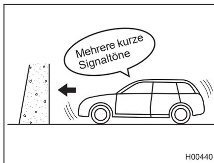
Wenn das System eingreift, wird ein Warnsignal mit wiederholten kurzen Signaltönen ausgegeben, und es wird ein Unterbrechungsbildschirm angezeigt.
