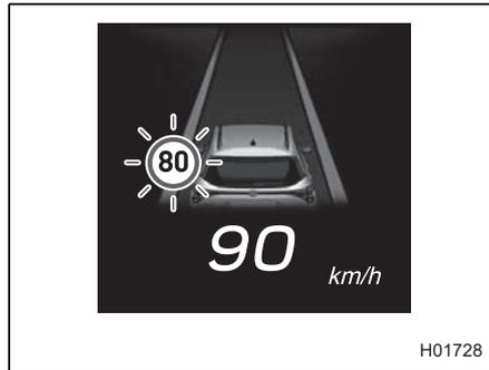
Wenn mehrere Anzeigen für Verkehrszeichen angezeigt werden, blinkt die obere rechte Anzeige für Verkehrszeichen (einschließlich der ergänzenden Anzeige für Verkehrszeichen, falls diese angezeigt wird).
