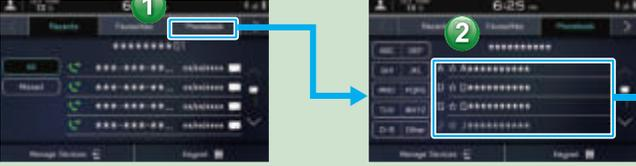
Die Benachrichtigungseinstellung des Bluetooth-Telefons muss möglicherweise aktiviert werden, damit das Telefonbuch heruntergeladen werden kann. Wenn die Einstellung des Telefonbuch-Downloads ausgeschaltet ist und kein Telefonbuch heruntergeladen wurde, wird eine Nachricht angezeigt und das Telefonbuch des verbundenen Bluetooth-Telefons kann heruntergeladen werden. S.87
