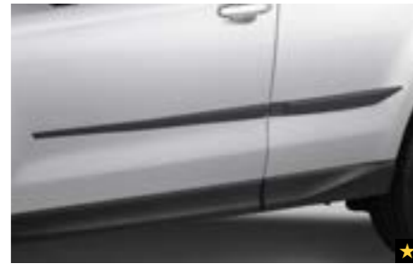
17 Seitenschutzleistensatz J105EAJ003 Ergänzt die Designelemente und schützt die Karosserie-seite.
