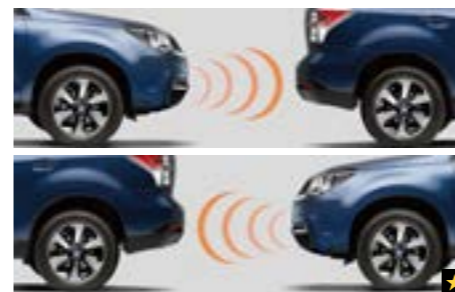
79 Ultraschall Einparkhilfen für vorne und hinten H485ESG100/H485ESG200/H485ESG000 Sicheres Einparken mit jeweils vier Sensoren durch akustische Warnungen.
