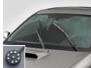
60 ★ E Regensensor SEWAYA8000 Aktiviert die Scheibenwischer, sobald Wasser auf die Scheibe fällt.
