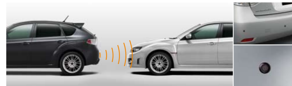
65 Ultraschall Einparkhilfe für vorne / hinten SEWAFG2100 / SEWAYA2000 ★ E Vorne: Erleichtert das Einparken wesentlich. Aktivierung über Geschwindigkeitssignal. Akustische Warnung. Hinten: Erleichtert das Einparken wesentlich. Aktivierung durch Einlegen des Rückwärtsganges. Akustische und optische Warnung.
