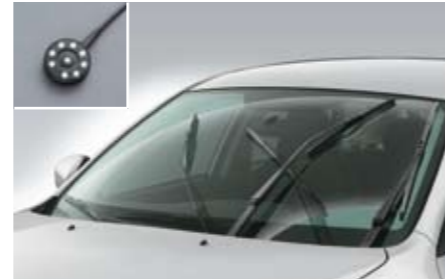
44 Regensensor SEWAYA8000 ★ E Aktiviert die Scheibenwischer sobald Regen auf die Scheibe fällt. *Mit beleuchtetem Schalter zum Aktivieren/Deaktivieren.
