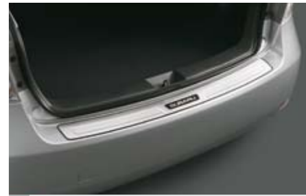
10 Stoßfängerschutzleiste Edelstahl E7710FG000 ★W Zum Schutz vor Kratzern beim Einladen.
