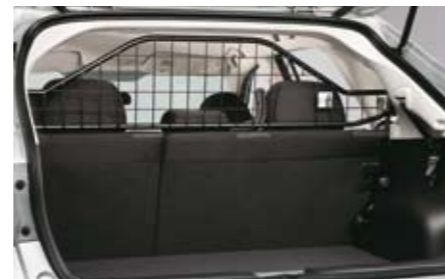
49 Laderaumtrenngitter F555EFG000 ★ W Trennt den Laderaum vom Insassenbereich, auch bei Verwendung von ISOFIX-Kindersitzen geeignet.
