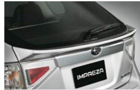
9 Heckklappenspoiler E725EFG000 ★W Betont den sportlichen Look des Hecks. *Lackierung und andere Gasdruckstoßdämpfer notwendig.
