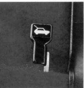
Von innen entriegelbare Heckklappe
