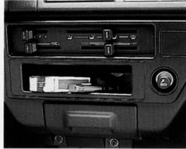
Zusätzliche Ablage, bzw. Radio-Schacht
