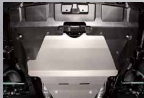
40 Motorunterfahrerschutz (Aluminium) ★ E515EAJ100/E515EAJ120 Zum Schutz des Motors vor Beschädigung von unten. *Voraussichtlich lieferbar Dezember 2009. Einbausatz zur Montage zusätzlich notwendig.
