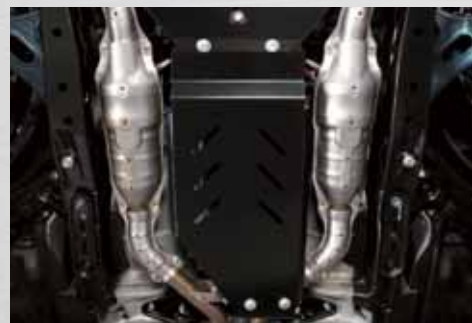
42 Getriebeunterfahrerschutz ★ E515EAJ200/E515EAJ220 Zum Schutz des Getriebes vor Beschädigungen von unten. *Voraussichtlich lieferbar Dezember 2009. Einbausatz zur Montage zusätzlich notwendig.
