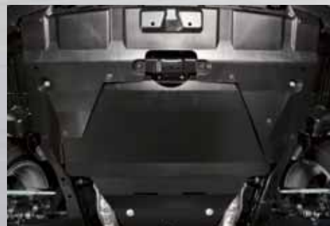
41 Motorunterfahrerschutz (Stahl) ★ E515EAJ000/E515EAJ020 Zum Schutz des Motors vor Beschädigung von unten. *Voraussichtlich lieferbar Dezember 2009. Einbausatz zur Montage zusätzlich notwendig.
