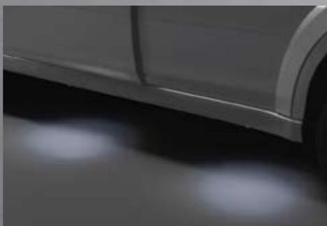
101 Bodenlampen für Schweller ★ H4715AJ000 Zur Beleuchtung der Seite und eines Bereichs unter dem Fahrzeug. Das Licht wird beim Entriegeln der Türen aktiviert. *Kabelbaum erforderlich.
