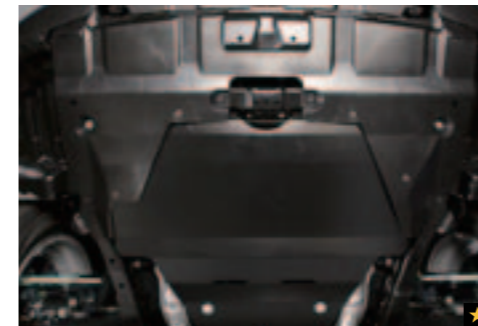
42 Motorunterfahrerschutz (Stahl) E515EAJ000/E515EAJ020 Zum Schutz des Motors vor Beschädigung von unten. Einbausatz zur Montage zusätzlich notwendig.
