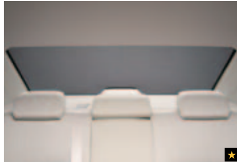
92 Sonnenschutzelement (Heckscheibe) F505EAJ010 Zum Schutz vor Sonneneinstrahlung, für mehr Komfort im Innenraum.
