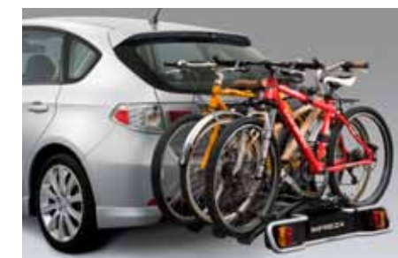
48 Fahrradaufsatz für Anhängerkupplung, System Thule (für 3 Räder)
